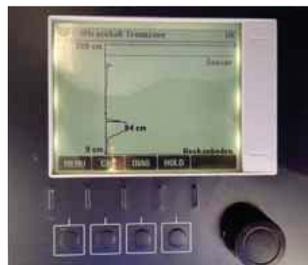
Aufzeichnung des Schlammspiegels mit dem Liquiline CM44x
